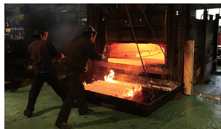
▲金属を硬くする「焼入れ」。この後、金属を粘り強くする「焼戻し」を行い出荷。目には見えない技術だが、人の命を預かるものを作る使命感を感じます
