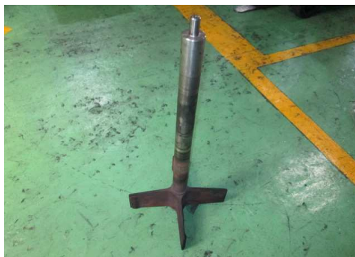
交換後の古い攪拌機
