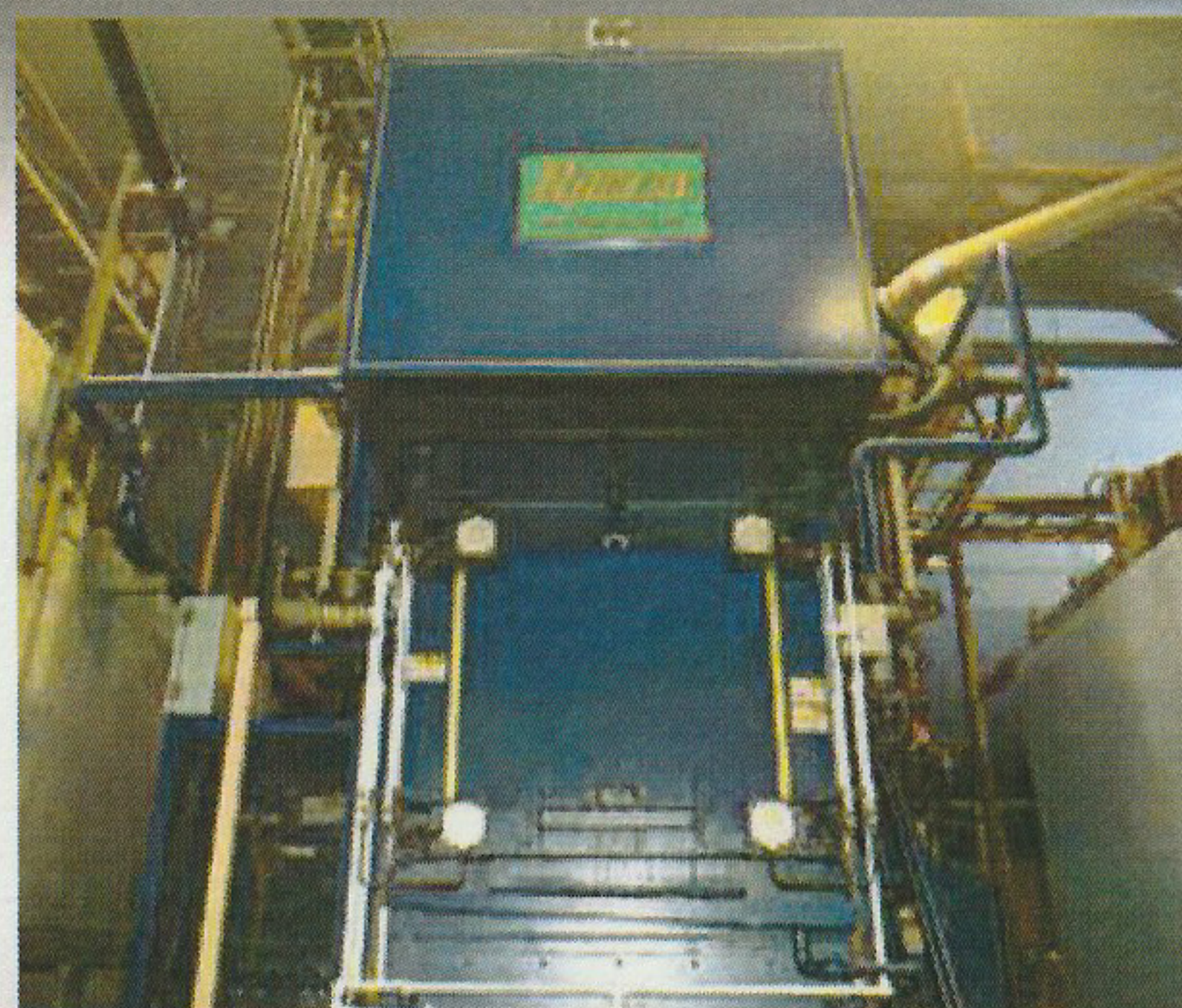
スペリア式高性能・真空型多目的ガス浸炭炉 1基
