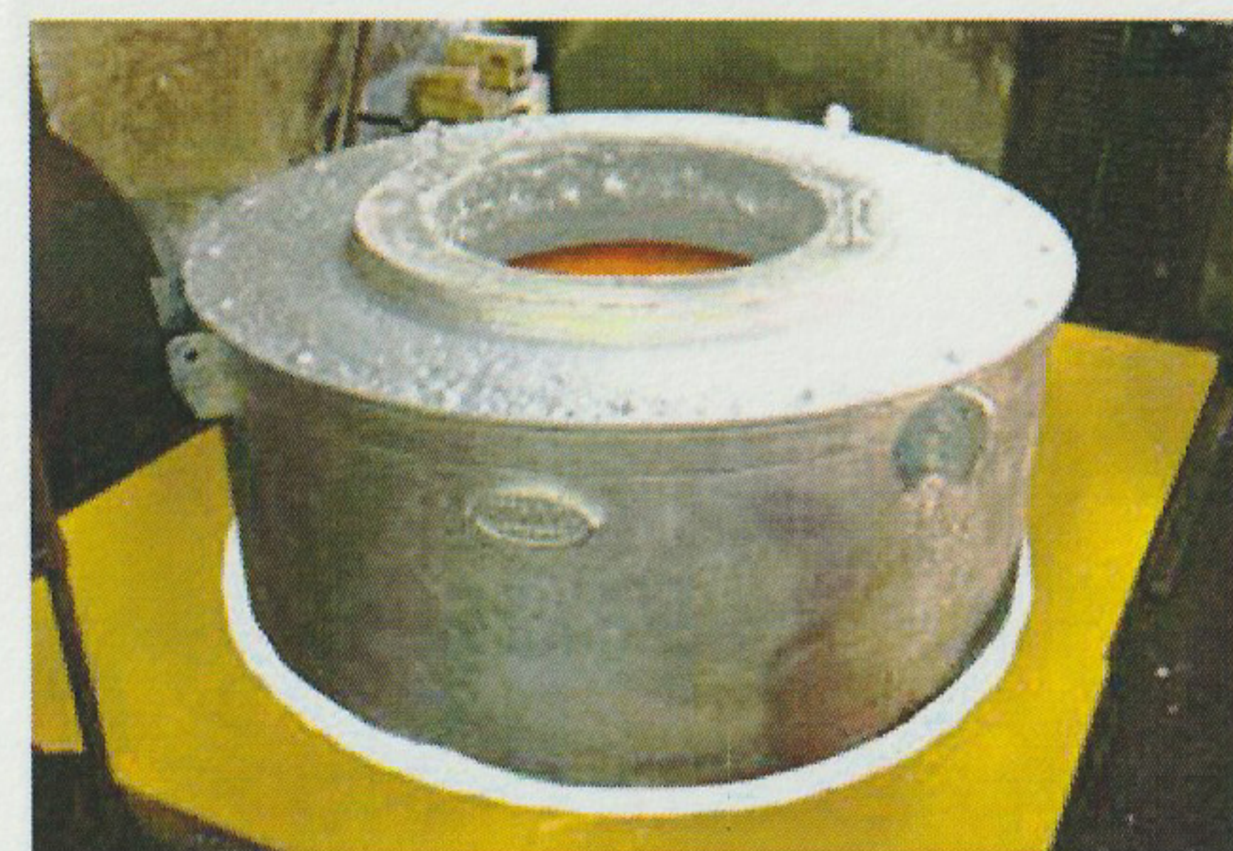
ソルトバス炉 1基 有効寸法:φ900×1,155H
