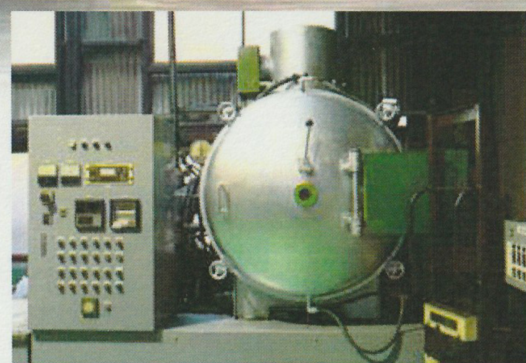
真空炉 1基 有効寸法:300W×250H×450L ※急速ガス冷却
